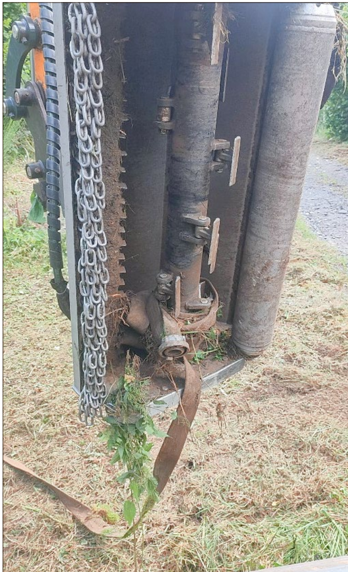
Fotos zeigen in Mulcher eingedrehten alten Schlauch und Holzablagerungen. Festgestellt bei Arbeiten mit dem Mulcher in Brennersgrün. Fotos: Steinbach, Bauhof Lehesten
